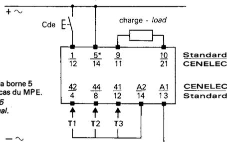
Nota : Le repérage sur la face arrière du module est "standard"
