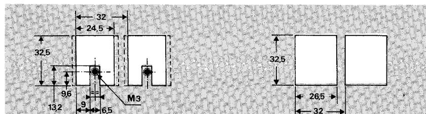
Vissé sur tôle - Screwed on metal panel
